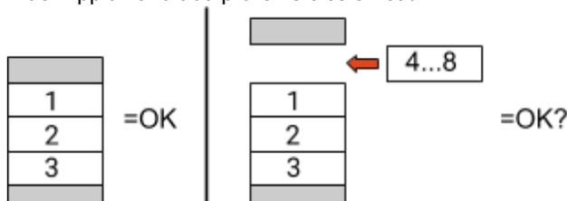
3. **Wenn nicht in Ordnung**: Das fehlerhafte Modul ist wahrscheinlich eines der Module im Turm. Nehmen Sie eines der Ersatzmodule und tauschen Sie jedes der verbleibenden Module einzeln gegen das Ersatzmodul aus. Überprüfen Sie nach jedem Schritt den Batteriestatus. Wenn der Batteriestatus auf "OK" wechselt, dann ist das zuletzt herausgenommene Modul vermutlich fehlerhaft.
