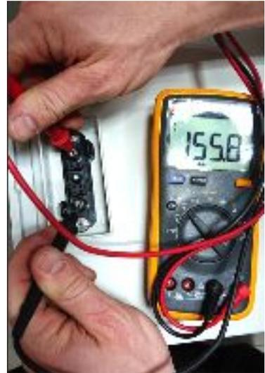
Wenn die gemessene Spannung erheblich vom Nennwert abweicht, überprüfen Sie bitte die elektrische Spannung an den einzelnen Modulen wie folgt:
