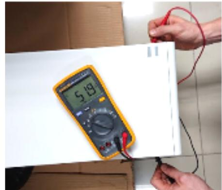
Ein Modul, in dem eine der 32 (HVS) / 16 (HVM) - Batteriezellen eine Spannung von  $<1,5$  V hat, ist in Unterspannung (wenn möglich mit BCP (Abschnitt 2.5) / BC prüfen).
